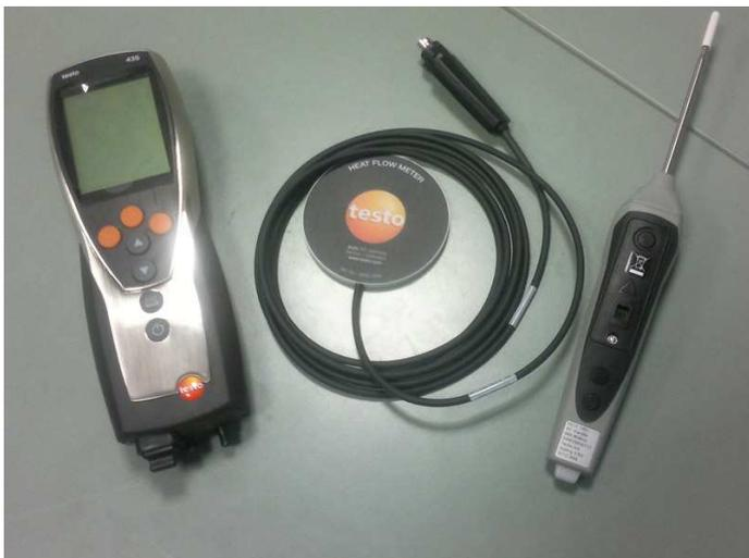
Immagine di un flussimetro con cavi e sonde per i rilevamenti
