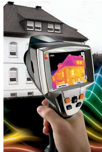
Sopra, telecamera all'infrarosso. Sotto, fotogramma con evidenza della dispersione termica di un edificio civile.
