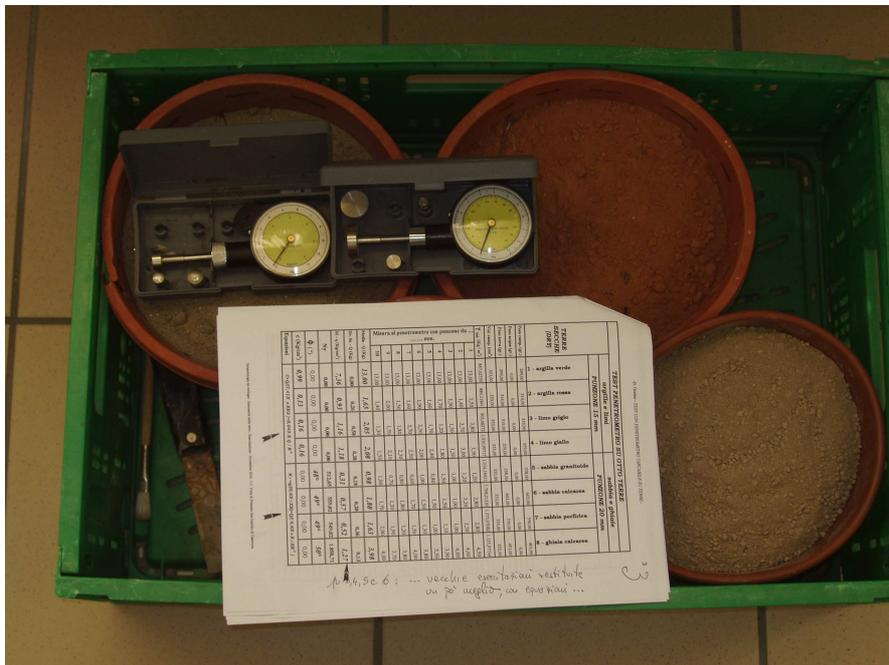
Laboratorio di scienze: gli strumenti utilizzati sono due *Geotester* manuali con cinque puntali di diverso diametro. Gli strumenti sono stati tarati preventivamente su una bilancia. (Classe 3za I.T.T.-C.A.T. - 2016-2017)
