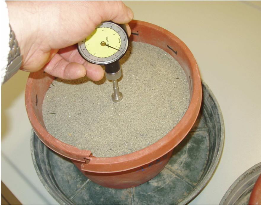
Laboratorio di scienze: rilievo di  $Q$  con il Geotester su sabbia granitoidale del Po con punzone da 15 mm. in condizioni secche. (Classe 3za I.T.T.-C.A.T. - 2016-2017)
