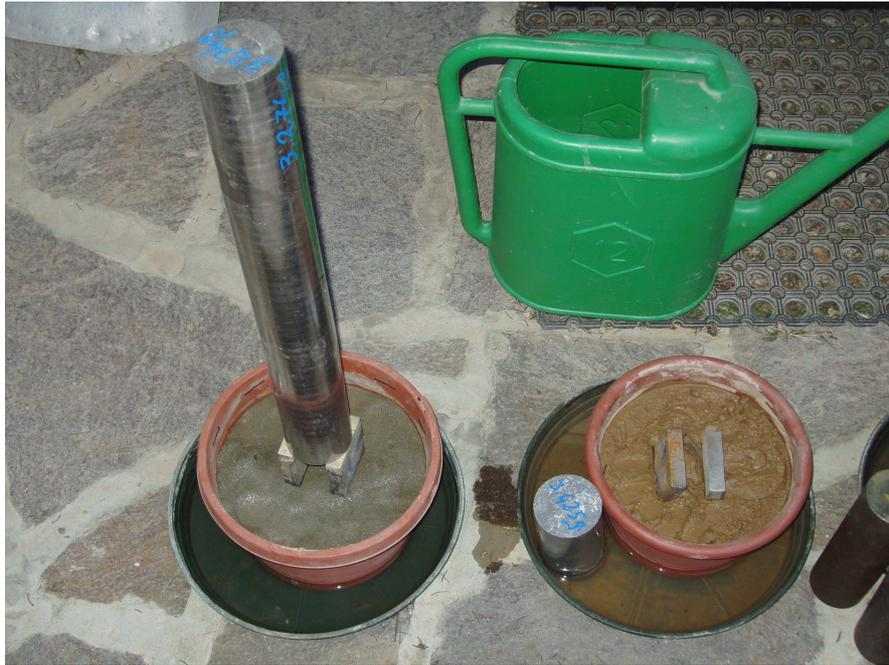
Verifica sperimentale della  $Q$  limite delle terre saturate. A sinistra la sabbia del Po che resiste ad una sollecitazione di 14 Kg su una fondazione di  $18 \text{ cm}^2$ . A destra il limo giallo che cede ad una sollecitazione di 4 Kg su una fondazione di  $18 \text{ cm}^2$ .
