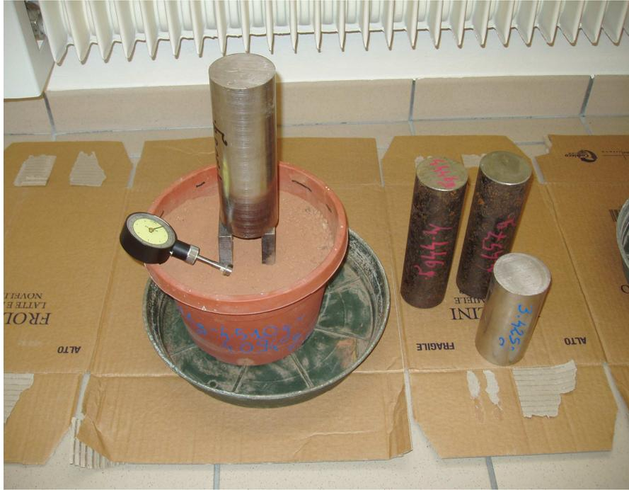
Laboratorio: verifica sperimentale della  $Q$  limite delle terre secche.
