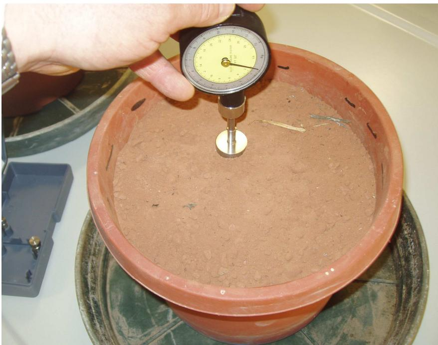
Laboratorio di scienze: rilievo di Q con il Geotester su argilla rossa del Werfen con punzone da 25 mm. in condizioni secche (Classe 3za I.T.T.-C.A.T. - 2016-2017)
