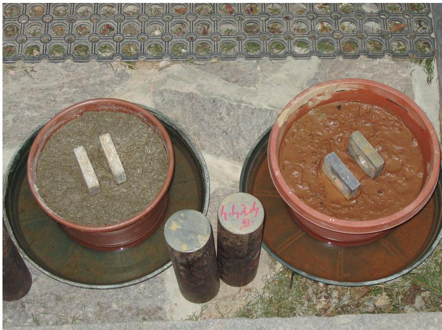
Verifica sperimentale della  $Q$  limite delle terre saturate. A sinistra il limo grigio ed a destra l'argilla rossa, entrambe collassate a seguito di una sollecitazione di 5 Kg su una fondazione di  $18 \text{ cm}^2$ .
