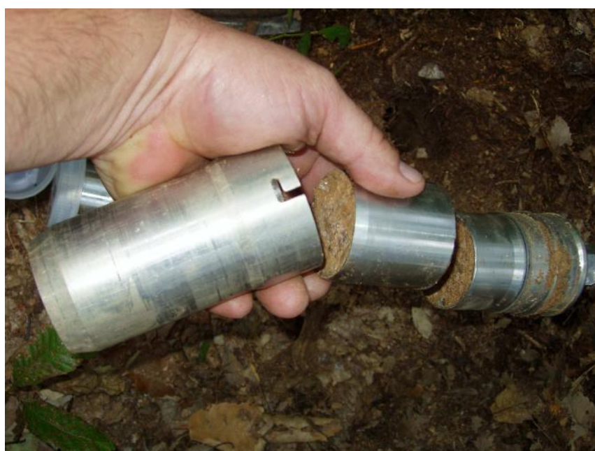
Immagini di repertorio. Prelievo di campioni indisturbati con campionatore da profondità.
