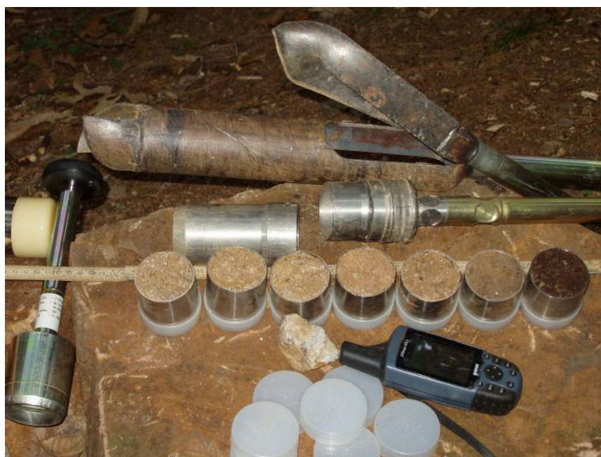
Immagini di repertorio. Prelievo di campioni grossolani, disturbati, mediante carotaggio (sopra) ed indisturbati mediante campionatori (sotto).
