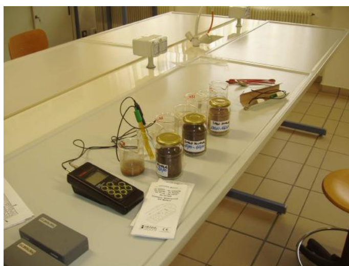
Laboratorio di scienze: Taratura del piaccametro e misurazione del pH dei suoli di tre orizzonti del profilo. (Piaccametro Hanna Instruments ).
